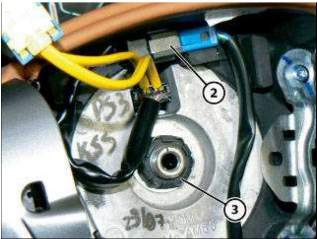
● 在装入相关的垫圈后，拧紧固定螺母 (3)，将方向盘装入其座中。
